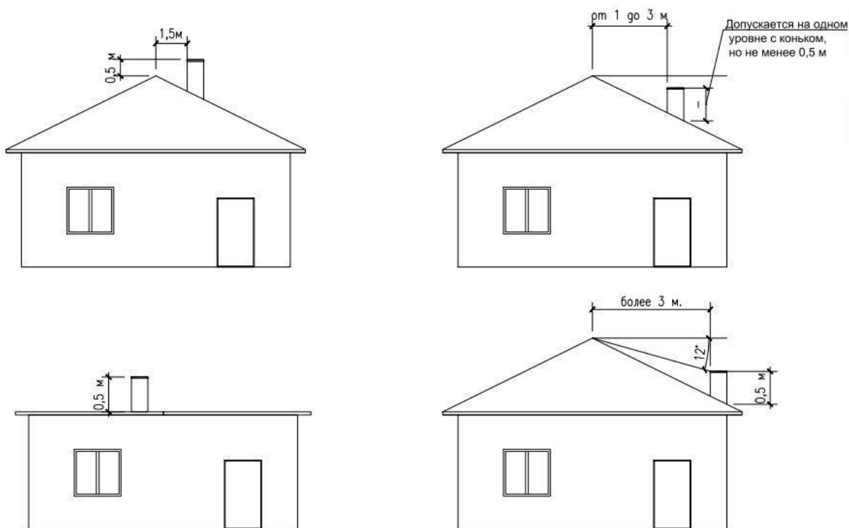
Рисунок 2. – Вылет дымохода над кровлей
